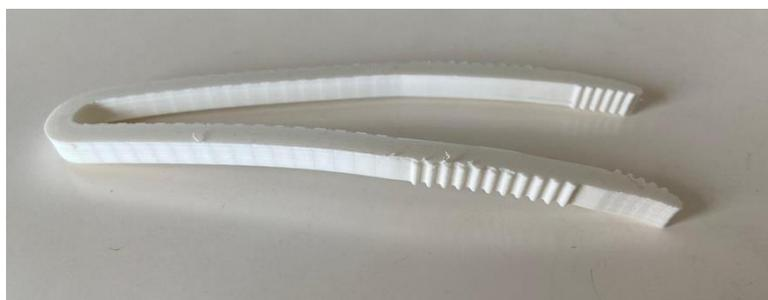
**Figura 33** – Pinça cirúrgica após uma esterilização de 10 minutos, seguida de uma esterilização de 5 minutos.
